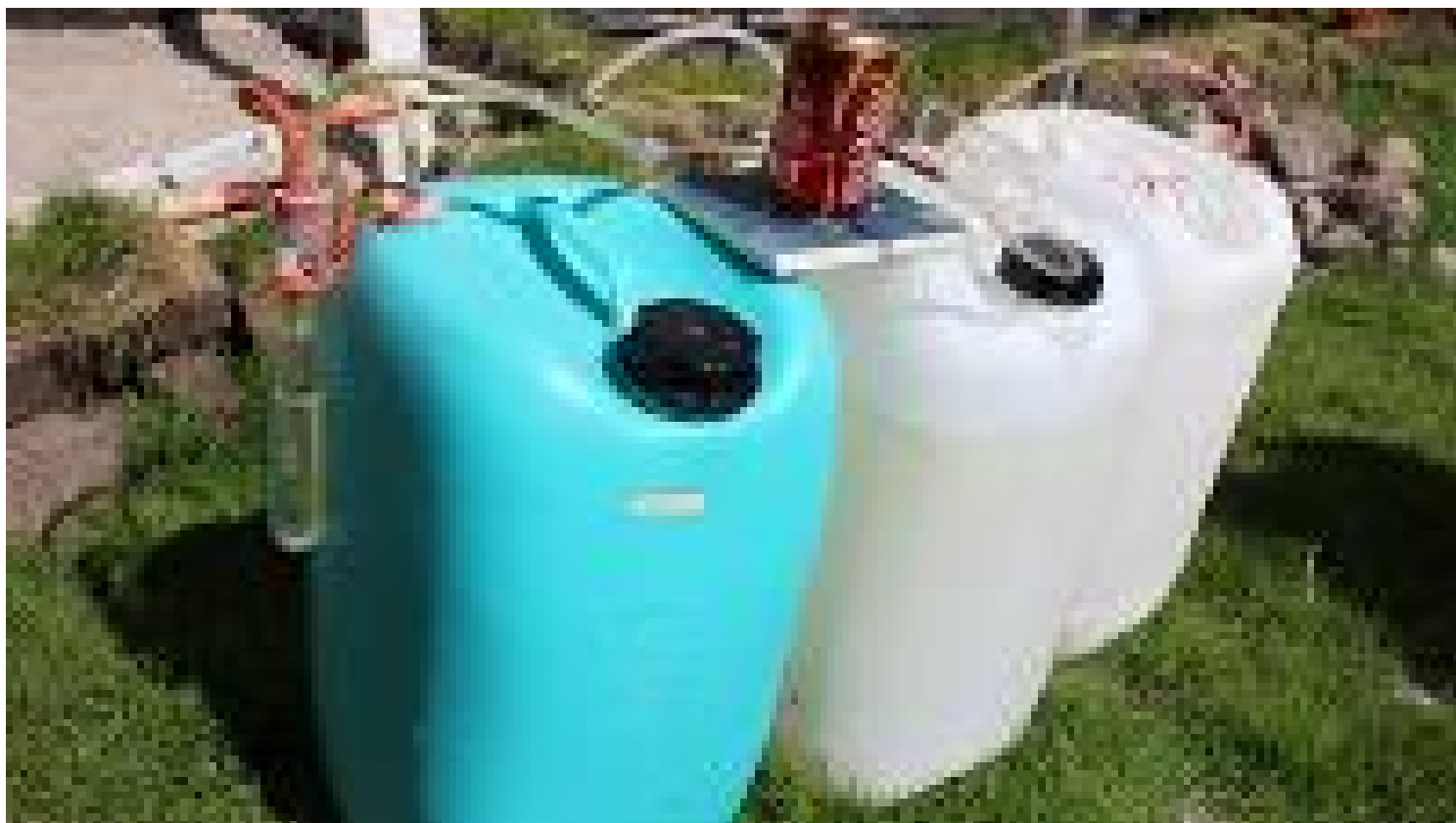
Anders har lavet denne simple opsætning af et biogas-anlæg. Anlægget bruges bl.a. i undervisning af skolebørn.
